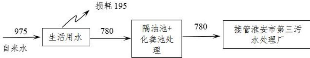
图 3.4-1 水量及水平衡 (m³/a)
