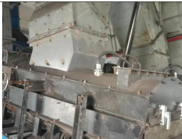
输煤系统（喷雾抑尘装置）
