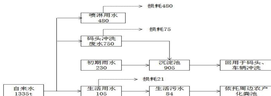
图 4-1 本项目水量及水平衡图 (t/a)
