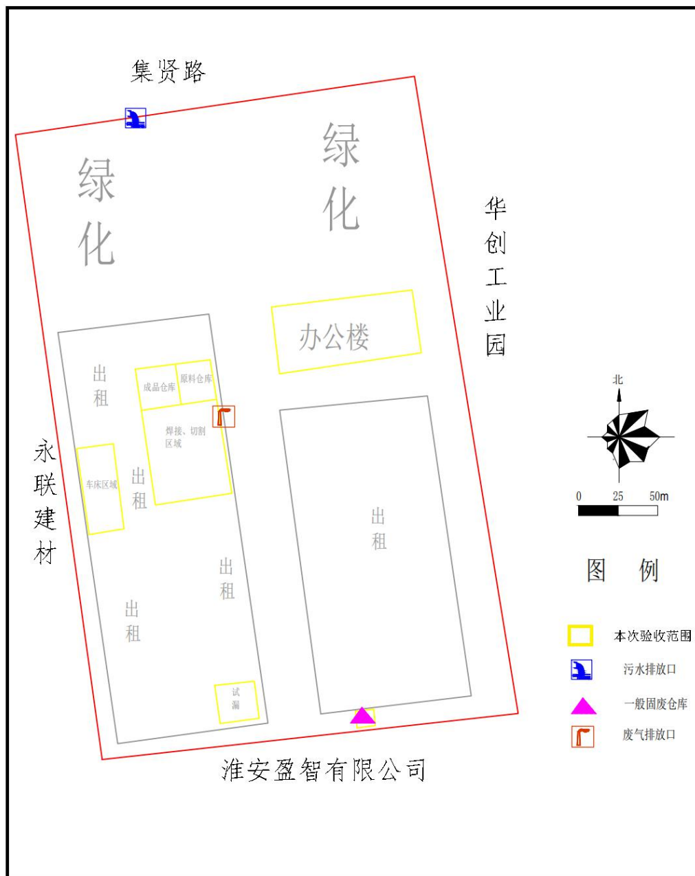
图 3.1-3 建设项目厂区平面布置
