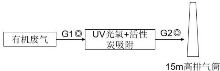
图 7.2-1 有组织废气监测点位图
