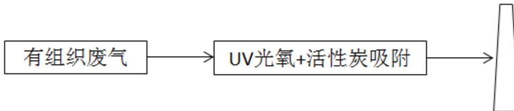
图 4.1-1 废气处理工艺图
