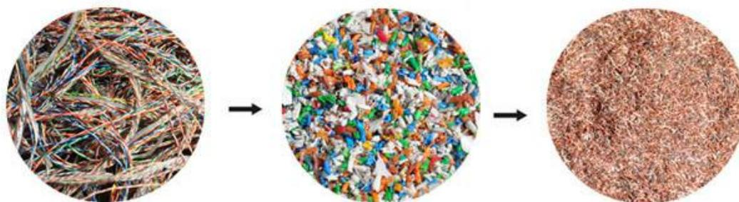
图 3.6-2 废旧电线电缆铜米机破碎示意图
